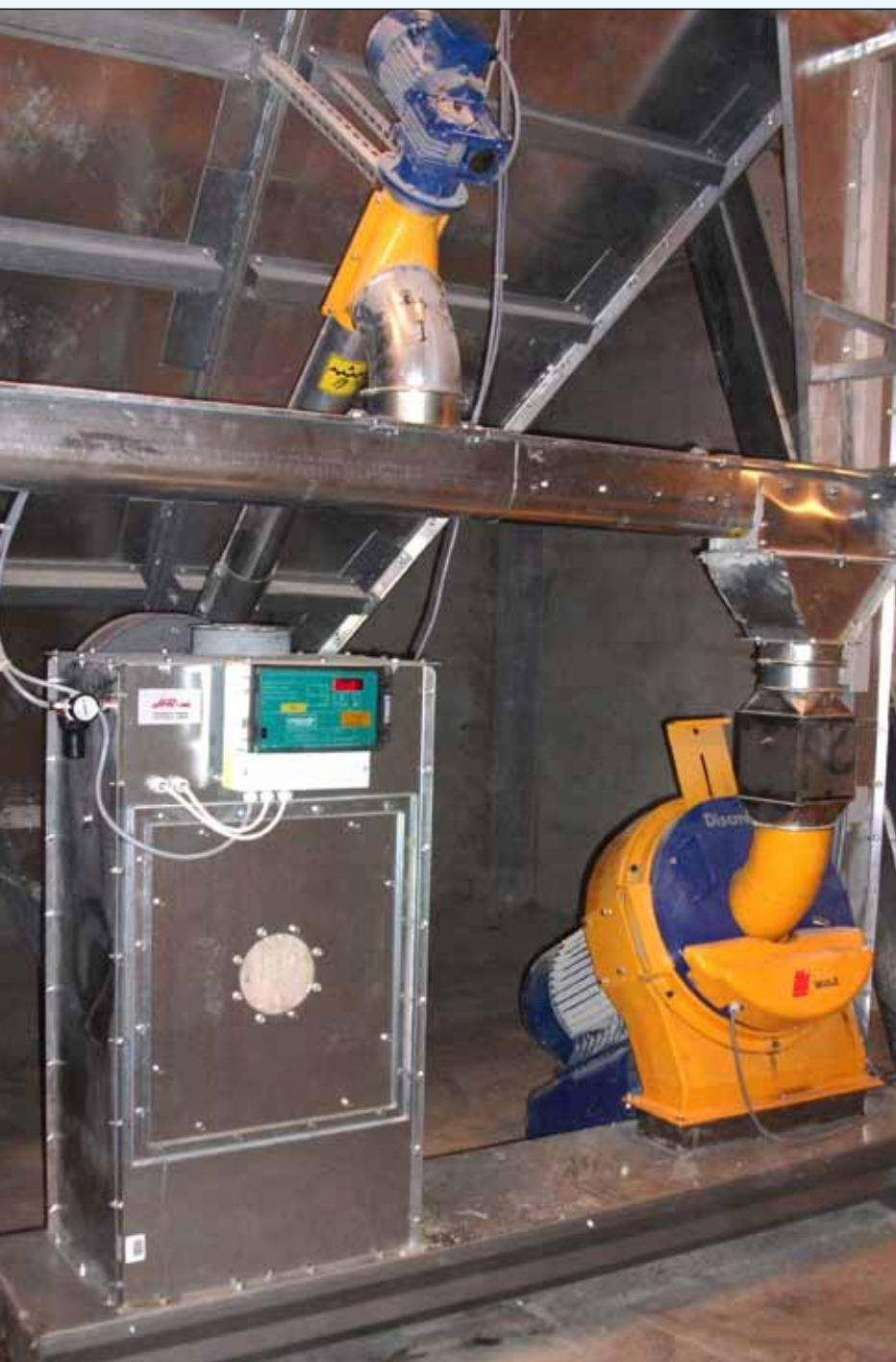
Nem adgang til filterskift gennem let aftagelig inspektionslem.
